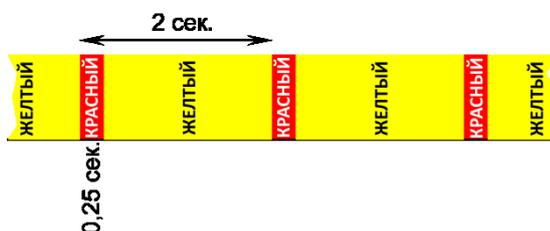
6.14. Если по окончании заряда напряжение на аккумуляторной батарее остаётся ниже 1В на элемент, то признаётся, что батарея неисправна. Зарядное устройство сохраняет пониженный ток заряда. Светодиодный индикатор светового прибора горит зелёным, но периодически через 2 секунды мигает красным секунды на 0,25 секунды, показывая низкое напряжение батареи. Если световой прибор подключен к ЩАО BS-АСТЕОН-2, то групповой индикатор «АО НОРМА» в ЩАО BS-АСТЕОН-2 гаснет до устранения неисправности.
