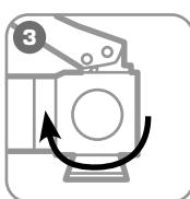
Поверните винт сброса давления в положение «Закрыть»
