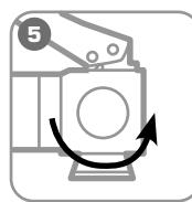
Поверните винт сброса давления в положение «Открыть»
