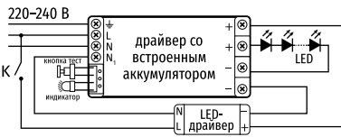
Схема подключения БАП в светильнике ДВО-14-А
