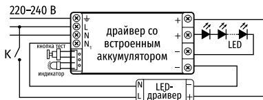
Схема подключения БАП в светильнике ДВО-12-А
