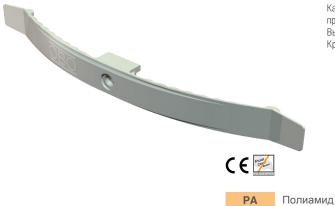
Кабельный зажим для универсального применения, например, для монтажа кабеля в промежуточных перекрытиях и перегородках. Высота зажима: 9 мм, с распоркой - 13 мм. Крепежное отверстие диаметром 6 мм.
