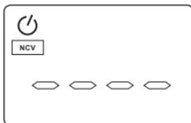
2) Нажмите кнопку «Hz/NCV» и переместите датчик бесконтактного обнаружения напряжения к исследуемому проводнику. Если детектируемое переменное напряжение превышает 90 В, то прибор обнаружит наличие напряжения. При этом замигает лампа подсветки, и включится звуковой сигнал.
