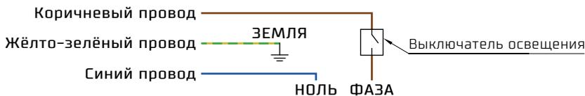
**ВНИМАНИЕ!** Вид подключения проводов **должен обеспечить необходимый уровень взрывозащиты.**
