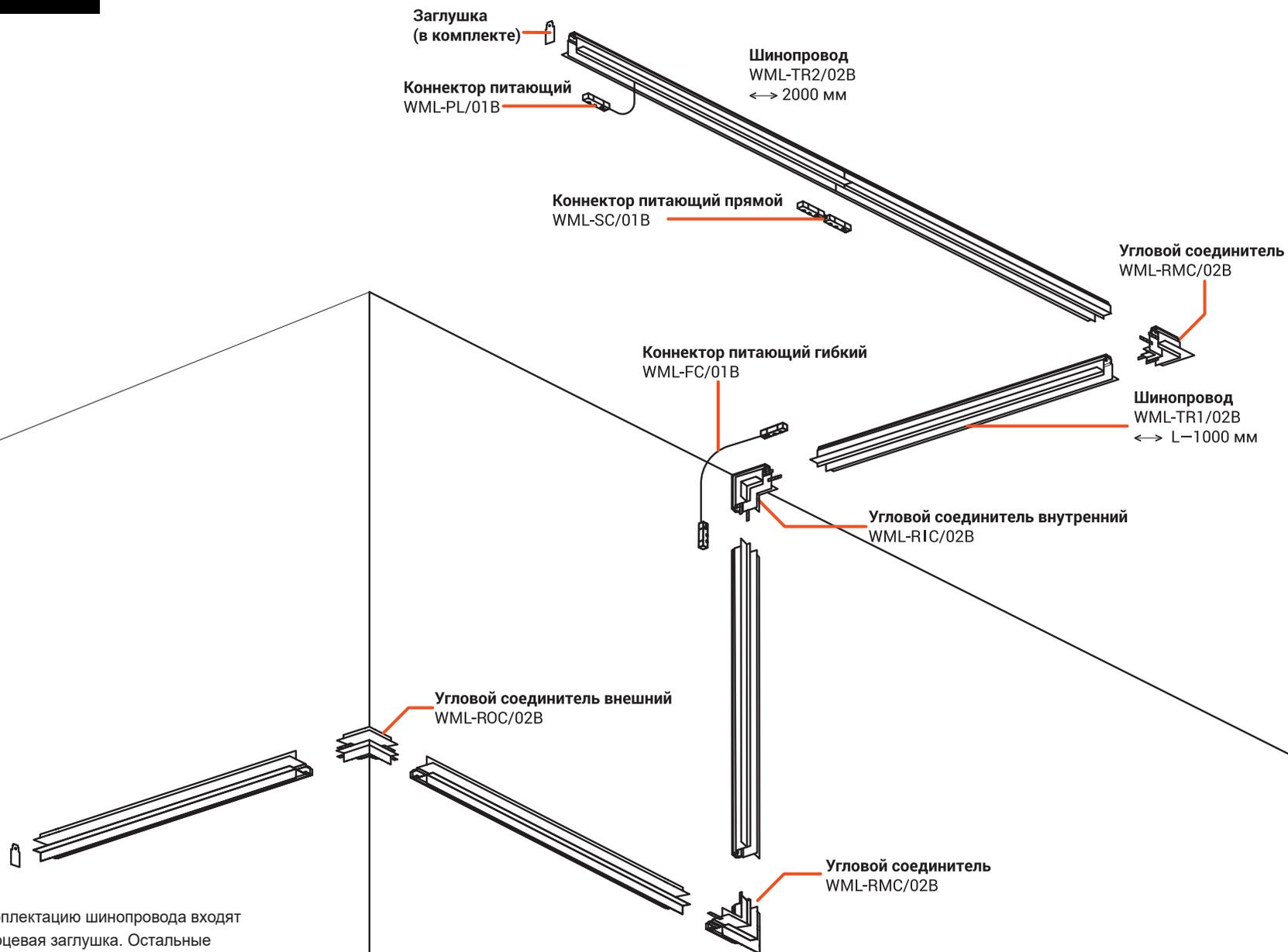
\* — В стандартную комплектацию шинпровода входят шинпровод и торцевая заглушка. Остальные аксессуары приобретаются отдельно.
