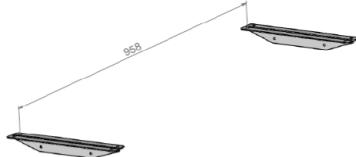
2. Распакованный светильник закрепить на потолочных кронштейнах, идущих в комплекте.
