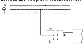
2. Схема підключення світильника до мережі живлення з регульованим драйвером за системою 1-10 V або системою DALI.
