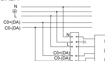
3. Схема подключения светильника к питающей сети с блоком резервного питания.
