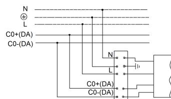
3. Схема підключення світильника до мережі живлення з блоком резервного живлення.
