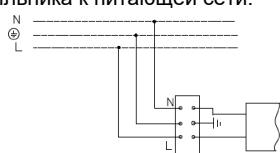
2. Схема подключения светильника к питающей сети с регулируемым драйвером по системе 1-10 V или системе DALI .
