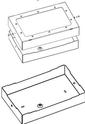
3. Завести подводящий провод через изолятор. Установить на опорную поверхность согласно установочным размерам (монтажный крепеж в комплект поставки не входит).
