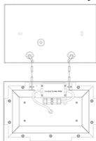
5. Открутить ответную часть конектора, завести питающий провод в конектор. Жилы провода соединить с конектором в соответствии с маркировкой.
