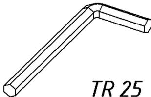
2. Распаковать светильник. Снять со светильника тыльную часть, открутив боковые винты ключем с головкой TR25 (входит в комплект).
