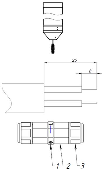
3.2. Установить светильник на вертикальную опору(диаметр 60 мм),зафиксировав его с помощью 3 винтов,усилие затяжки (7+1 )Нм.
