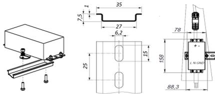
3.4. Підключити двожильний кабель до драйверу через кабельний з'єднувач (йде в комплекті), дотримуючись полярності (" + " - (L), " -" - (N)).
