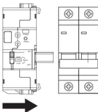
Рис. 5 – Присоединение моторного привода
