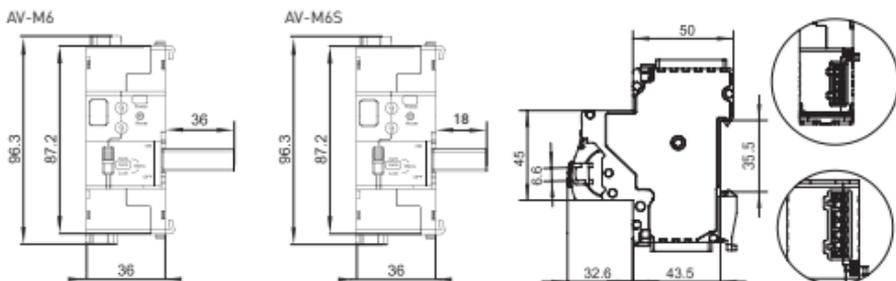
Рис. 4 - Габаритные размеры привода AV-M6/AV-M6S
