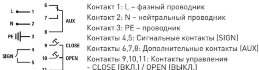
Рис. 7 – Схема подключения моторного привода
