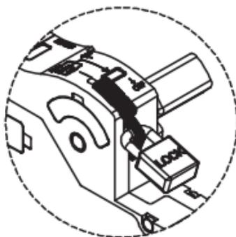
Рис. 3 - Блокировка навесным замком
