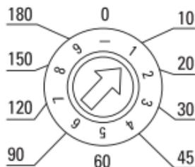
Рис. 2 - Задержка автоматического взвода (в секундах)
