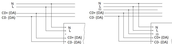
3. Схема підключення світильника до мережі живлення з блоком резервного живлення: (на мал. а - світильник, б - блок резервного живлення).
