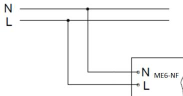
5. Схема подключения светильника к питающей сети с регулируемым драйвером и блоком резервного питания: (на рис. А - выносной блок).
