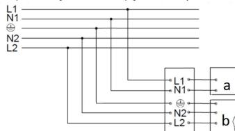
4. ME6-NF модулі бар және реттелетін драйвері бар қоректендіруші желіге шамшырақты қосу схемасы.
