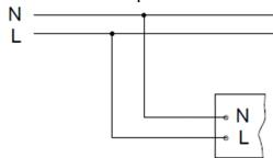
2. Схема подключения светильника к питающей сети с регулируемым драйвером по системе 1-10 V или системе DALI .
