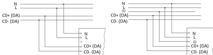
3. Шамдалдың резервтік қуаттандыру блогы бар қуаттандыру желісіне қосылу сымбасы (суретте a - шамдал, b - резервтік қуаттандыру блогы).
