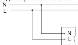
2. Схема підключення світильника до мережі живлення з регульованим драйвером за системою 1-10 V або системою DALI.
