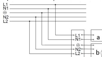
4. Схема подключения светильника к питающей сети с регулируемым драйвером и модулем ME6-NF.
