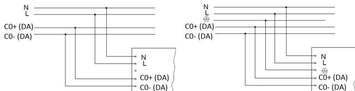
3. Схема подключения светильника к питающей сети с блоком резервного питания (на рис. а - светильник, б - блок резервного питания).
