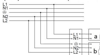
4. Схема підключення світильника до мережі живлення з регульованим драйвером та модулем ME6-NF.
