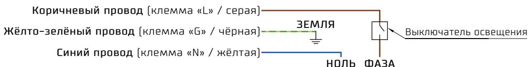
> В исполнениях «DC» красный провод – «+», чёрный – «минус», заземление может отсутствовать.
